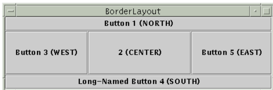
Figure 18. Exemple d'utilisation d'un BorderLayout
