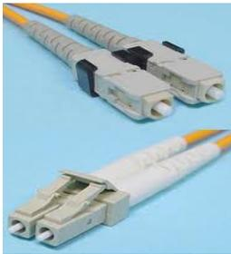
On utilise donc entre les bâtiments pour relier deux commutateurs (et parfois dans un même bâtiment entre le SR et le RG) de la fibre optique (**fil en verre souple** et fin comme un cheveu qui permet de transmettre les données sous la forme d'ondes lumineuses).
