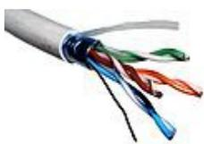
Pour le câblage des réseaux à l'intérieur des bâtiments, on utilise actuellement du câble à paires torsadées (FTP – Foiled Twisted Pair) constitué de huit  **fils de cuivre torsadés par paire**. Selon la date d'installation, on trouvera certaines catégories de câble. Une catégorie limite les possibilités de débit (cat 5 : 100 Mbits/s, Cat.6 : 1 Gbits/s , Cat.7 : 10 Gbits/s).
