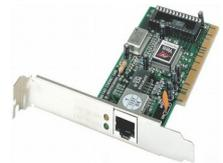
**La carte réseau fait office d'interface entre l'ordinateur et le câble du réseau.** Elle peut être intégrée à la carte mère ou installée dans un connecteur d'extension (slot) de l'ordinateur :
